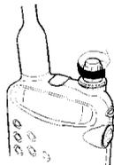
Sie können die Schrittweite des Frequenzwahlschalters auf ca. 1.000 MHz erhöhen, indem Sie die Funktionstaste beim Drehen gedrückt halten (vgl. Kap. Individuelle Einstellungen • Fast Step).
