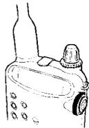
Wenn Sie den Rauschsperrnregler weiter zudrehen, wird das Gerät im Ansprechen immer unempfindlicher. Ganz zuge dreht ist Funkempfang nur aus unmittelbarer Nähe möglich.
